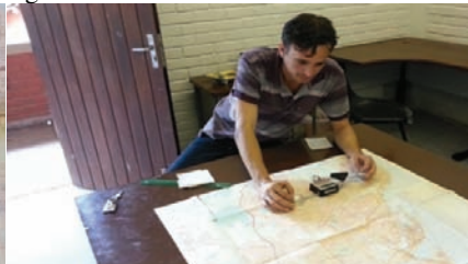
Figura 65- Modo de uso do Planímetro.
